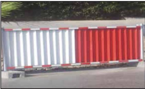
Palissade galvanisé, suivant model dimension: 2m x 1m, cadre en tube rond diamètre 42 habillé avec une tôle ondulée de 2m x 1m.
